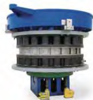
Generalüberholter Leitapparat für eine vertikale 38-MW-Francis-Turbine.
