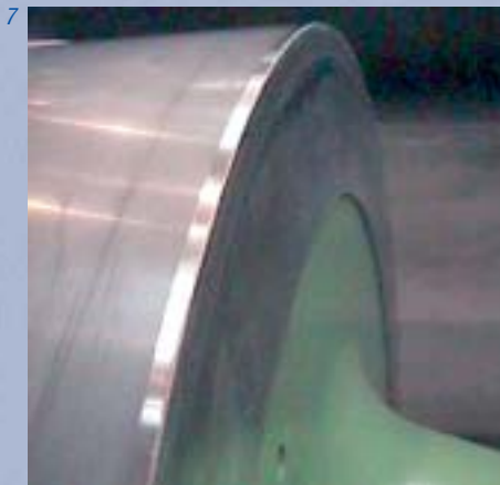
Abb. 9: CeraLease-Beschichtung mittels Hochleistungs-Plasma.
