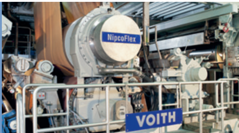
Abb. 3: Die Kartonmaschine 2 nach dem Umbau. Im Vordergrund Siebsaugzylinder der Einlagen mit FloatLip-Formern.
