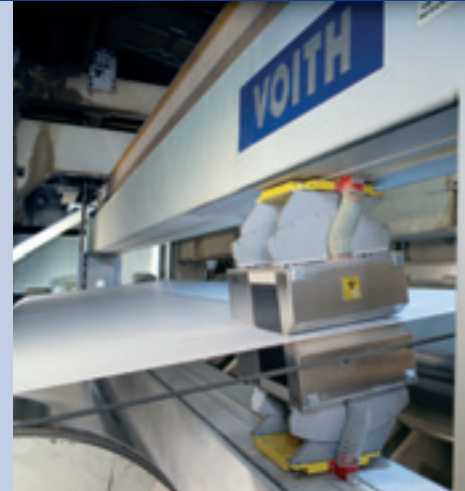
Die OnQ Messrahmen sind aus einer stabilen Kastenkonstruktion, die für eine hohe Verwindungssteifigkeit sorgt.
