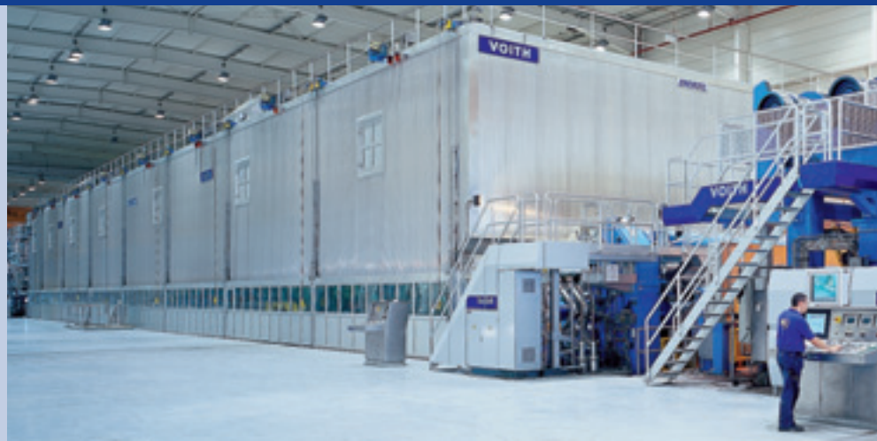
TopDuoRun Trockenpartie und Sirius-Aufwicklung.
