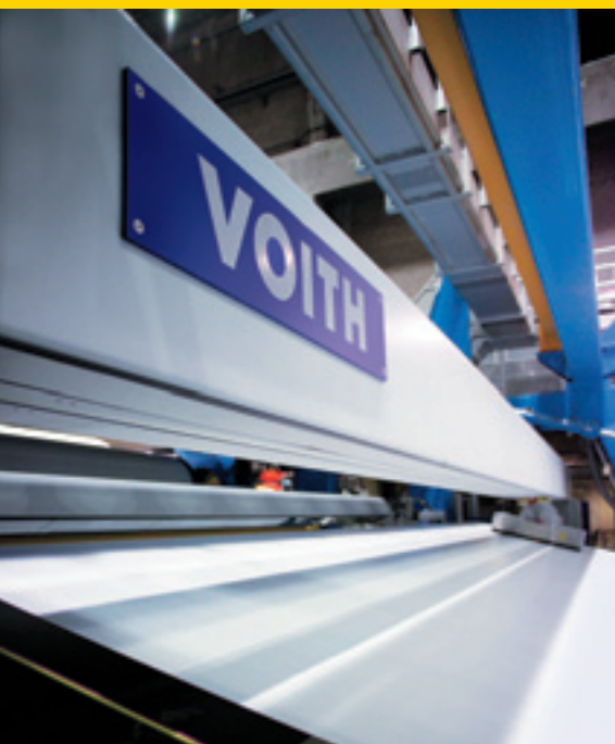
Der OnQ GradeManager überwacht anhand der vom Scanner gemessenen Daten den Sortenwechsel für Flächengewicht, Feuchte und Aschegehalt der Papierbahn.
