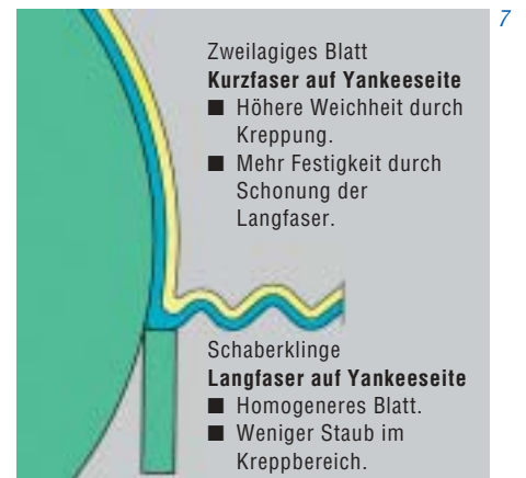
Abb. 7: Zweischicht-Tissue: Unterschiedliche Fasern auf Ober- und Unterseite.
