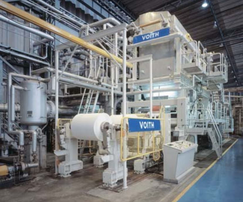
An der Voith Paper-Versuchsanlage in São Paulo werden neue Verfahren erprobt und Tests für Kunden durchgeführt.
