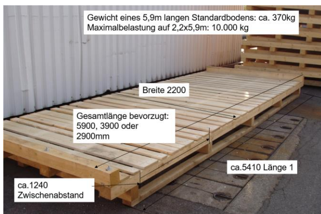
Abbildung 4: Maße und Ausführung offener Boden
